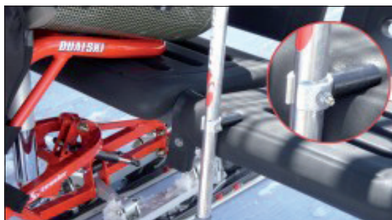
Obr. 26. Zadní trn Tessier stabilizátorů
